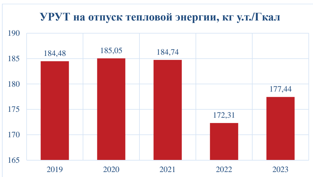
Рисунок 15 – Динамика изменения удельного расхода условного топлива на отпуск тепловой энергии ТЭЦ АО «РИР»
