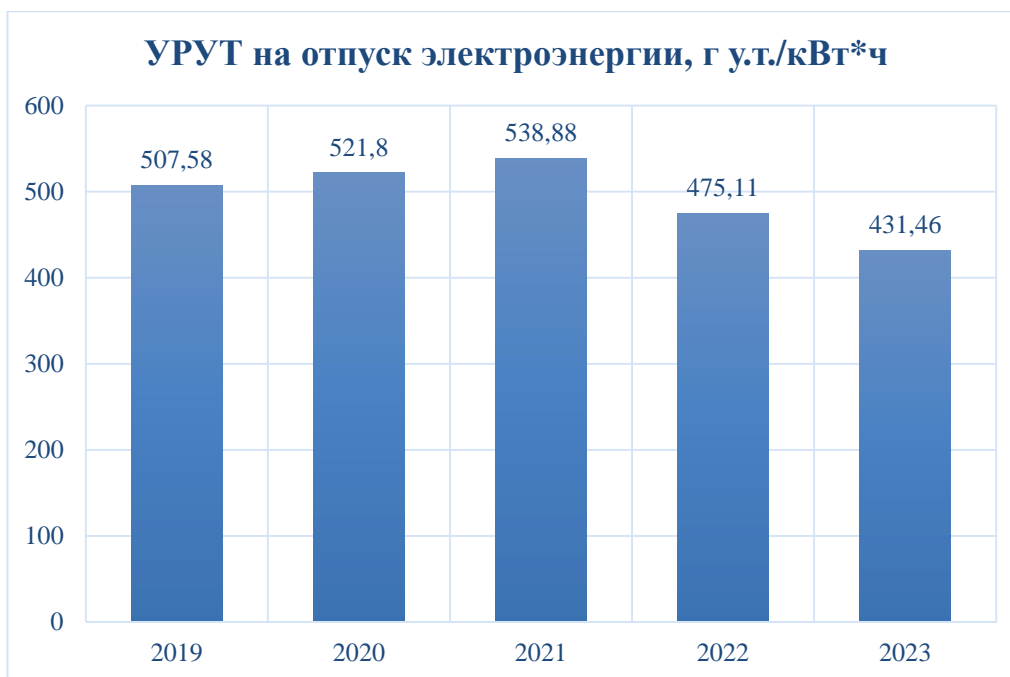
Рисунок 14 – Динамика изменения удельного расхода условного топлива на отпуск электрической энергии ТЭЦ АО «РИР»
